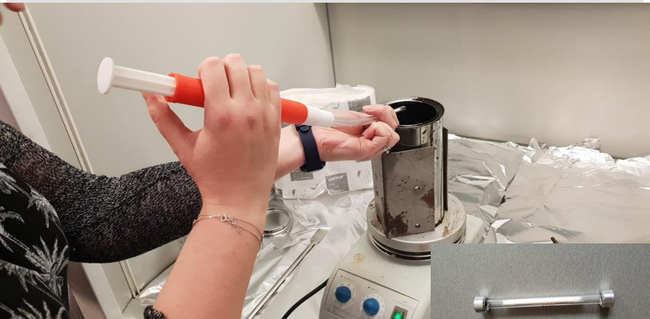
Pobieranie próby fazy gazowej z nad powierzchni asfaltu
